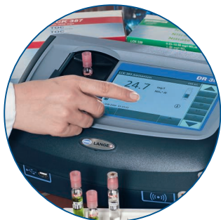
Εικ. 2: Φασματοφωτόμετρο για την ακριβή αξιολόγηση των των τεστ φιαλιδίου της LANGE, π.χ. για αναλύσεις αζώτου
